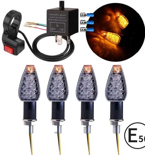
Den Strom für den 12V Blinkgeber einfach am Kontrollerkabel am besten beim Rücklichtkabel abgreifen.
